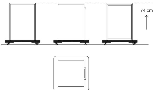
**Ausführung** Korpus und Bodenplatte aus MDF, in Strukturlack lackiert. Mit verschiedenen Optionen zur Integration von Technik sowie Datenanschlussfeldern.
